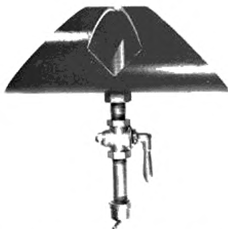
Рисунок 2 — Кран с вентилем для отбора проб на линии
