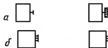
a — бабка фрезерная; б — многошпиндельный узел
