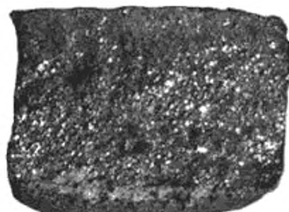
Рисунок Б.12 — Излом среднезернистый, кристаллический
