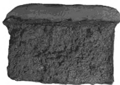
Рисунок Б.1 — Излом мелкозернистый, матовый
