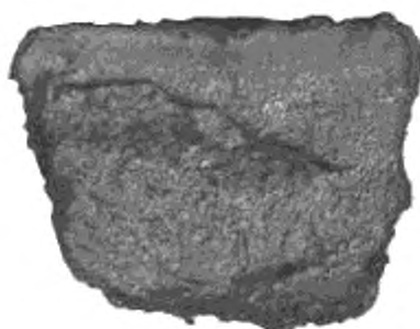
Рисунок Б.1 — Излом мелкозернистый, матовый
