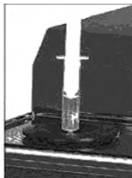
Рисунок 1 — Шприц, установленный в входное отверстие
