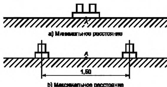
Рисунок В.1 — Установка акселерометров при определении f_2
