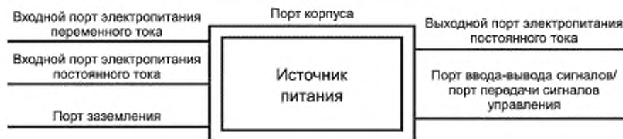
Рисунок 1 — Примеры портов источника питания
