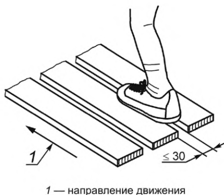
Рисунок 13 — Измерение щелей размером не более 30 мм
