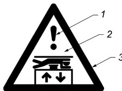
Рисунок 1 — Знак «Опасность снизу — Ограниченное пространство — Соблюдайте осторожность»
