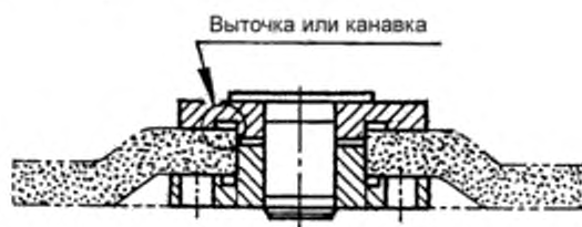
Рисунок 2 – Пример выточки или канавки на фланце
