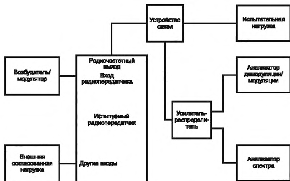
Рисунок 3 — Конфигурация оборудования при испытаниях: радиовещательные передатчики DRM [2] и T-DAB [3]
