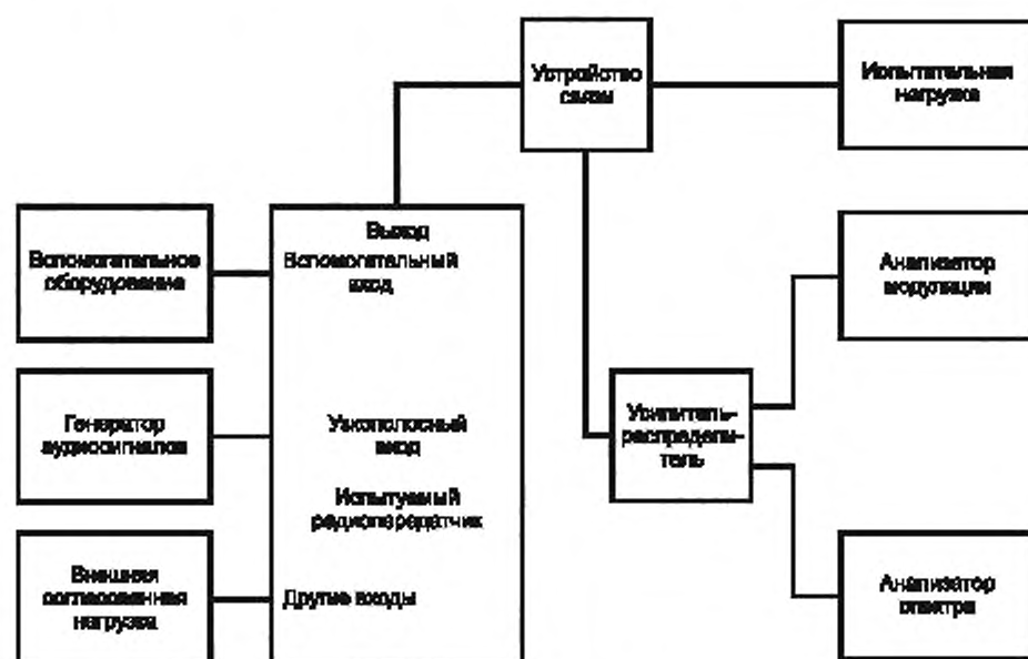
Рисунок 2 — Конфигурация оборудования при испытаниях: ДВ, СВ, КВ АМ радиовещательные передатчики
