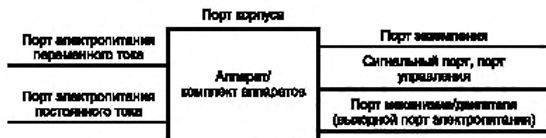
Рисунок 3 — Примеры портов аппарата/комплекта аппаратов
