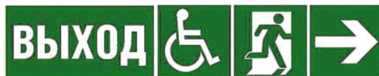
Рисунок 5 — Пример комбинации эвакуационных знаков
