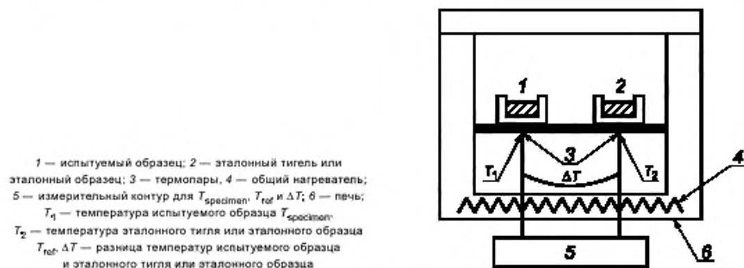
Рисунок ДА.2 — Схема прибора ДСК по тепловому потоку
