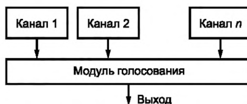
Рисунок А.4 — Голосование по мажоритарному принципу
