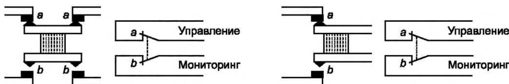
Рисунок А.1 — Контакты реле
