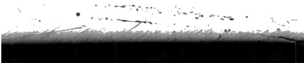
в — вид дефекта на микрошлифе (сопровожающийся строчками неметаллических включений), 100 х
