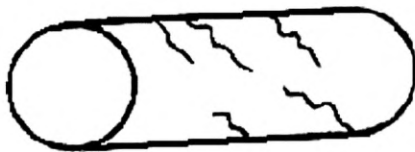
б — дефект на сортовом прокате
