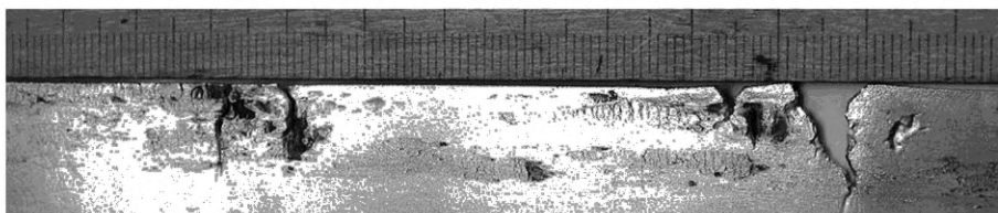
б — внешний вид дефекта на холоднокатаном прокате
