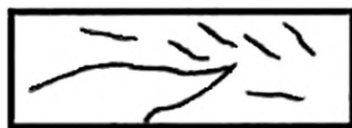
б — дефект в виде разветвленных линий
