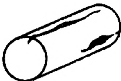
б — дефект на сортовом прокате
