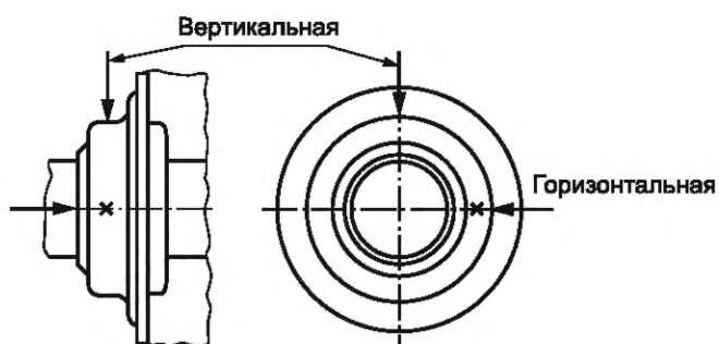
Рисунок В.2 — Точки измерения на корпусе подшипника
