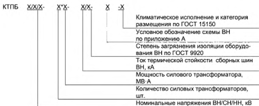
Рисунок 1 — Схема условного обозначения подстанции
