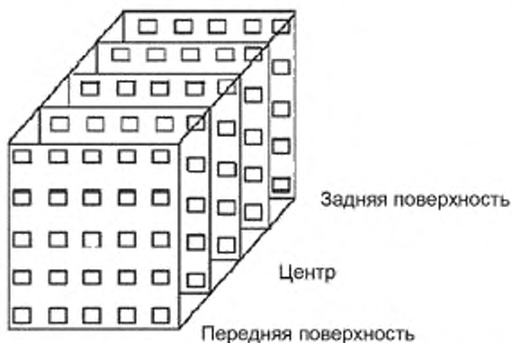
Рисунок 1 — Размещение дозиметров для картирования дозы в контейнере с продуктом в случае фотонного облучения
