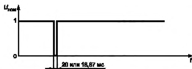
Рисунок В.2 — Прерывания напряжения \Delta U = 100\% в течение одного цикла при номинальной частоте
