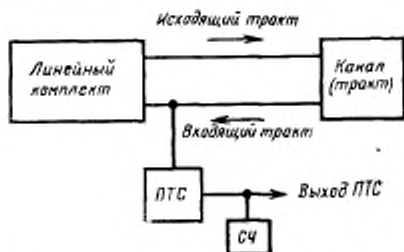
ПТС — приемник тональных сигналов; СЧ — счетчик импульсов.
