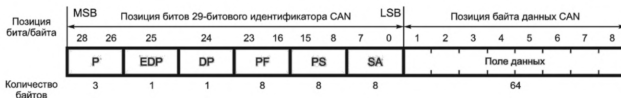
Рисунок Б.1 — Использование 29-битового идентификатора CAN и поля данных
