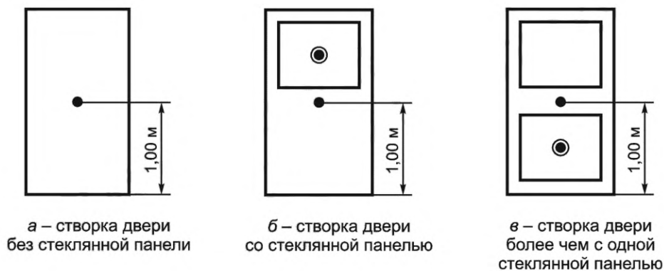
Рисунок 11, лист 1 — Створки двери — маятниковые испытания на удар — ударные точки
