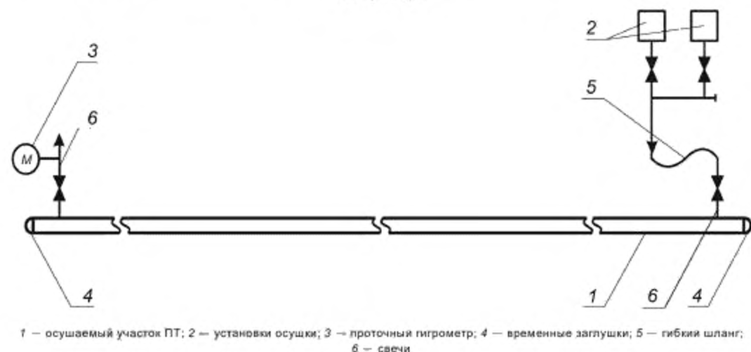
Рисунок Б.9 — Типовая технологическая схема осушки участка ПТ сухим воздухом
