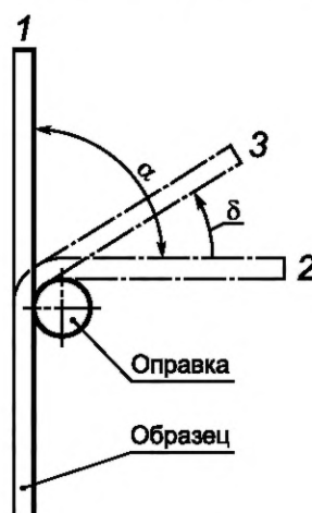
1 — исходное состояние; 2 — положение после изгиба; 3 — положение после разгиба
