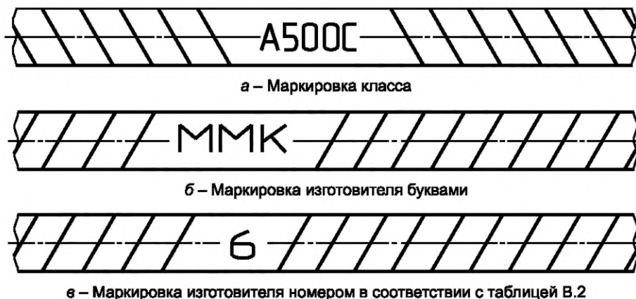
Рисунок В.1 — Маркировка проката надписью
