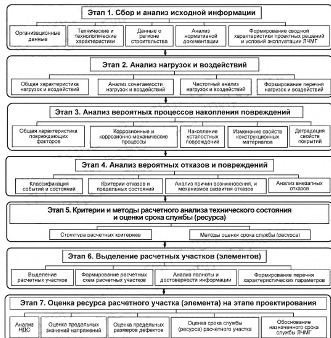
Рисунок А.1 — Схема алгоритма оценки срока службы (ресурса) ЛЧМГ при проектировании
