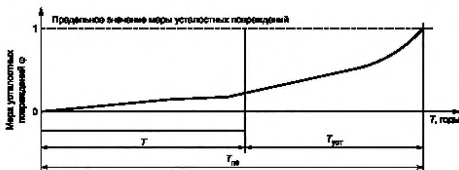
Рисунок Д.4 — Графическая интерпретация оценки срока службы расчетного участка ЛЧМГ с учетом повреждающего фактора «усталость» (код варианта 0010)
