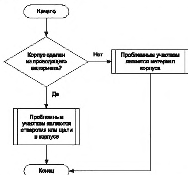
Рисунок 3 — Алгоритм выявления проблемных участков конструкции
