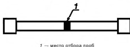
Рисунок 8.4 — Место отбора проб от образцов для испытаний на растяжение
