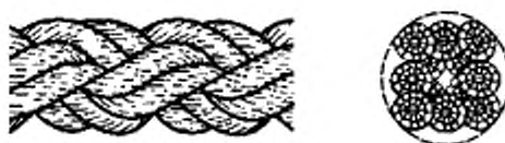
Рисунок 3 — Конфигурация 8-рядного плетеного каната (тип L)
