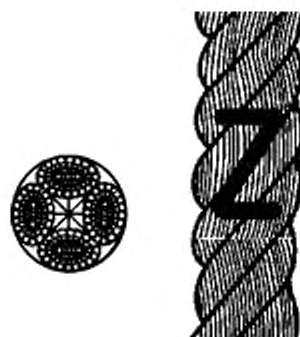
Рисунок 2 — Конфигурация 4-рядного крученого каната (тип В)
