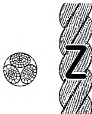
Рисунок 1 — Конфигурация 3-рядного крученого каната (тип А)
