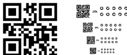
Рисунок 3 — Пример QR-кода, использующего квадратную сетку 21×21. Данный символ кодирует строку текста, которая должна читаться как «TestCode1». Способность прочесть данный код соответствует способности различать детали изображения, равные по размеру отдельным квадратам, составляющим данный код (или 1/21 размера всего поля кода). QR-коды требуют больше места для кодирования одинаковых по размеру различаемых деталей изображения. В данном случае в 21 раз больше различаемой детали, в то время как кольцо Ландольта по размеру только в пять раз больше различаемой детали. Альтернативным вариантом может быть применение колец Ландольта и QR-кодов на одном тестовом плакате для оценки технического зрения. Способность различать QR-код заданного размера эквивалентна считыванию смежного множества колец Ландольта
