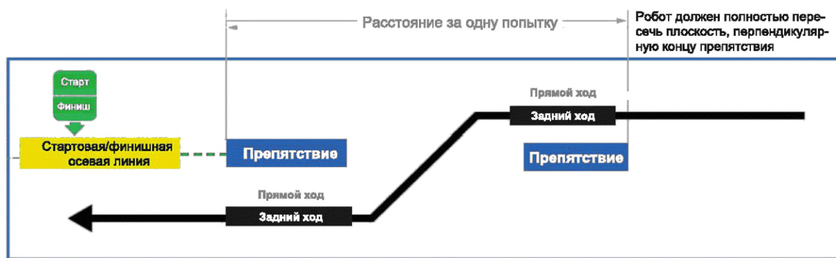
Рисунок 3 — Вид сверху на зигзагообразный маршрут (прямым и задним ходом), определяемый препятствиями
