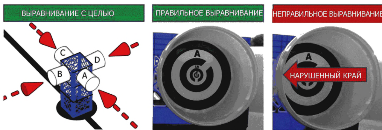
Рисунок 3 — Правильное и неправильное расположение робота на маршрутной линии
