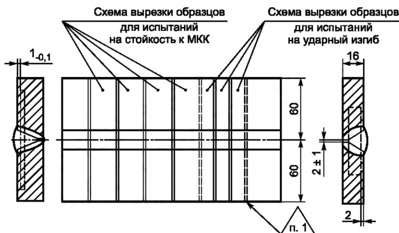
Рисунок В.8 — Контрольное сварное соединение
